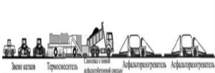
Рис. 3. Схема расположения машин в технологическом потоке
