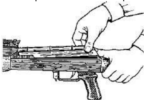
Рис. 13. Отделение крышки ствольной коробки
