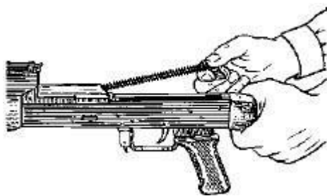
Рис. 14. Отделение возвратного механизма
