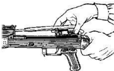
Рис. 15. Отделение затворной рамы с затвором
